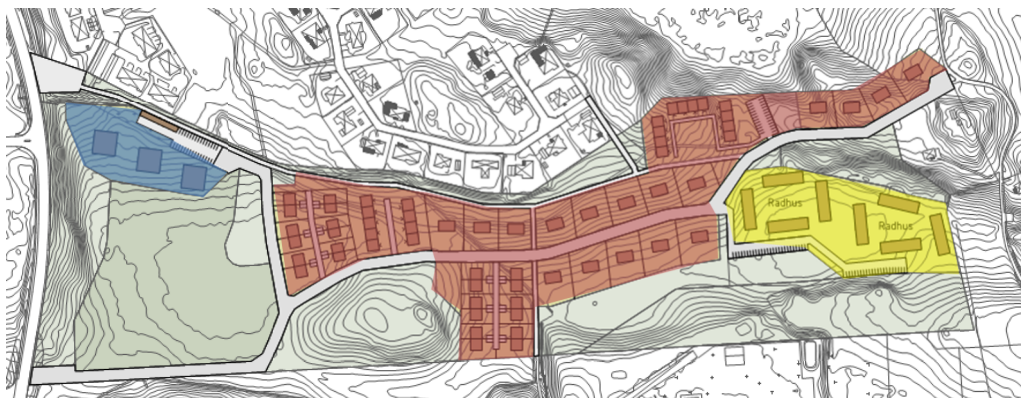
Figur 1. Situationsplan (underlag 5). På området ska olika typer av byggnader anläggas. Det blåmarkerade området visar var 5-våningshus ska byggas. Det rödmarkerade området visar var 1- eller 2-våningshus ska byggas. Det gulmarkerade området visar var radhus ska byggas.
